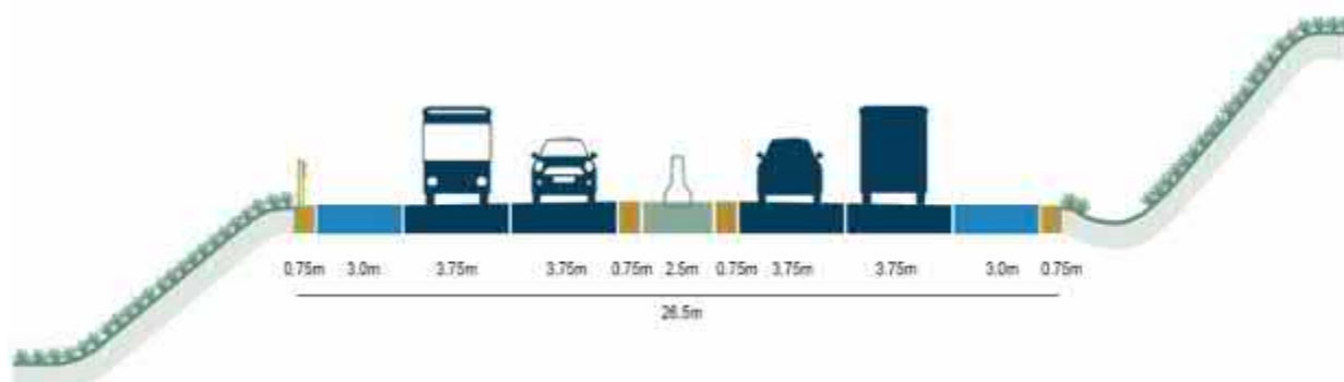
图 2.6-1 整体式路基标准横断面图（宽度 26.5m）
